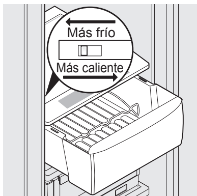
Cajón de enfriamiento con control de temperatura
