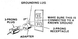
WARNING: THE GREEN GROUNDING LUC EXTENDING FROM THE ADAPTER MUST BE CONNECTED TO A PERMANENT GROUND SUCH AS TO A PROPERLY GROUNDED OUTLET BOX. NOT ALL OUTLET BOXES ARE PROPERLY GROUNDED.
