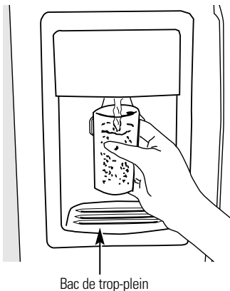
Bac de trop-plein
