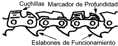
LAS CUCHILLAS DEBERAN APUNTAR EN DIRECCION A LA ROTACION
