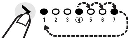
**REMARQUE :** À chaque pression de la flèche, un bip se fait entendre alors que le témoin lumineux se déplace au réglage suivant. Le témoin lumineux se déplace jusqu'au réglage "7", puis retourne au réglage "1".
