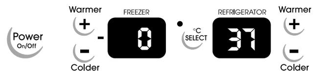
Pour mettre le réfrigérateur en marche, appuyer sur POWER (ON/OFF) (alimentation-marche/arrêt) pendant 2 secondes. Les points de réglage recommandés par l'usine sont 0°F (-18°C) pour le congélateur et 37°F (3°C) pour le réfrigérateur.
