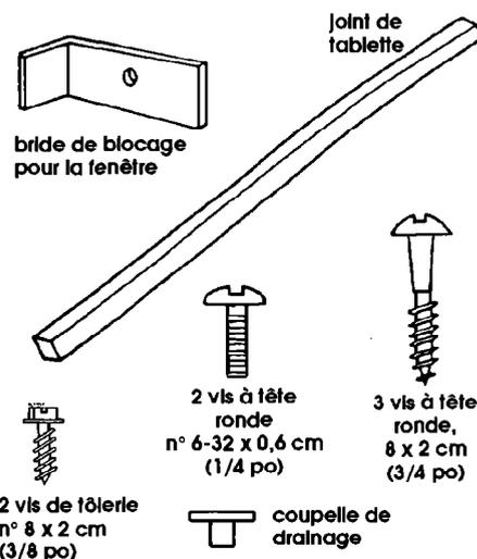
Les pièces nécessaires pour l'installation sont fournies pour les fenêtres à guillotine allant jusqu'à 101,6 cm (40 po) de largeur. Il est possible d'installer le climatiseur dans une fenêtre de 137 cm (54 po) de largeur; pour cela, utiliser l'ensemble de pièces spéciales disponible chez le concessionnaire ou au centre de service.
