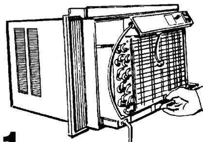
1. Débrancher le fil vert de liaison à la terre de l'appareil. Conserver la vis de liaison à la terre pour l'étape 5. Tirer sur la poignée pour extraire le climatiseur de la caisse, et le mettre sur le carton.
