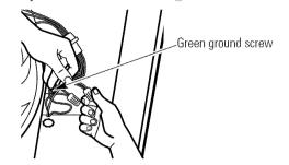
WARNING: IMPROPER CONNECTION OF <u>ALUMINUM</u> HOUSE WIRING TO THESE COPPER LEADS CAN RESULT IN A SERIOUS PROBLEM. <u>USE ONLY CONNECTORS</u> <u>DESIGNED FOR JOINING COPPER TO</u> <u>ALUMINUM</u> AND FOLLOW THE MANUFACTURER'S RECOMMENDED PROCEDURE CLOSELY.
