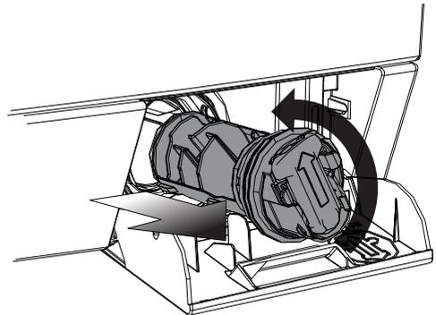
Inspeccione la junta tórica antes de reinsertar el filtro de la bomba.
