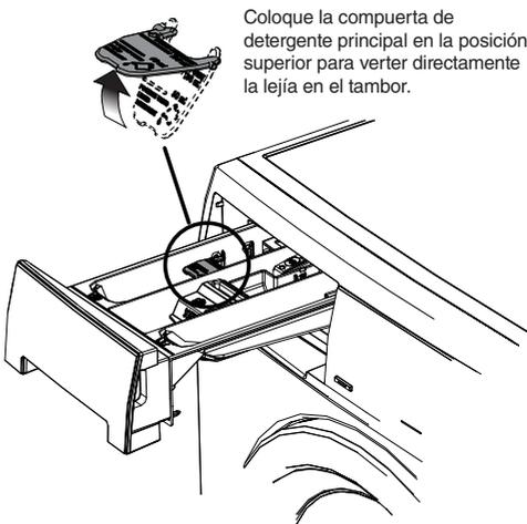
Coloque la compuerta de detergente principal en la posición superior para verter directamente la lejía en el tambor.
