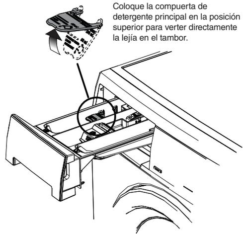
Coloque la compuerta de detergente principal en la posición superior para verter directamente la lejía en el tambor.
