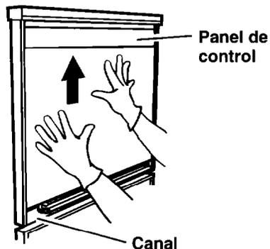
6. Enganche un extremo del retenedor en el canal como se muestra en la ilustración. Empuje hacia adentro mientras desliza el pulgar a todo lo largo del retenedor.
