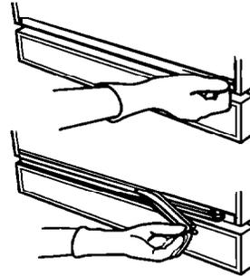
4. Levante el panel o los paneles de la puerta por los bordes exteriores. Use una mano para doblar la parte inferior del panel o los paneles. Quite el panel o los paneles y el espaciador. Guarde el panel o los paneles y el espaciador para uso futuro.
