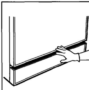
4. Asegúrese de que el panel de acceso se haya deslizado por el tope acanalado a lo largo de la parte inferior del marco del panel de acceso.
