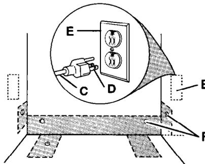
6. Instale en un gabinete adyacente un contacto de pared para conexión a tierra con 3 entradas que coincidan con los polos de la clavija.
