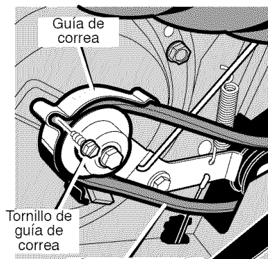
Correa de propulsión de la barrena Figura 18
