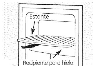
Para llegar al interruptor de corriente.
