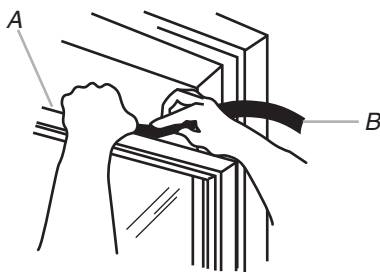
A. Sommet du châssis de la partie inférieure de la fenêtre B. Joint en mousse
