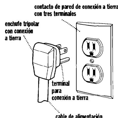
Para su seguridad personal, este deshumidificador debe estar conectado a tierra. Este deshumidificador está equipado con un cable de alimentación con un enchufe tripolar con conexión a tierra.
