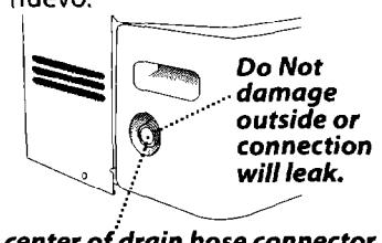
2. Haga un orificio en el centro del conector de la manguera de desagüe. Saque la pieza y tirela.
