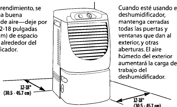
Instale el deshumidificador en un piso a nivel lo suficientemente fuerte como para soportar el deshumidificador con el balde de agua lleno.
