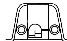
La posición "High": el Flotador de Nivel del Agua está preseleccionado en la posición de "high" al lado izquierdo de la abertura. El deshumidificador se apagará automáticamente cuando el balde esté 3/4 lleno.
