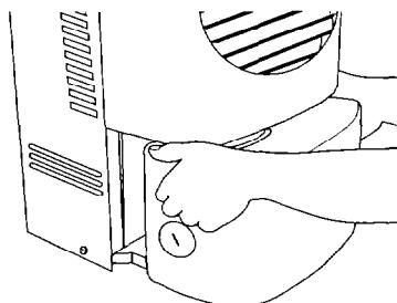
1. Levante el balde utilizando las agarraderas laterales. Tire del balde hacia usted, para sacarlo.
