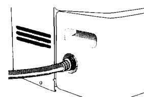
3. Coloque una manguera de patio en el conector de la manguera de desagüe. La manguera no debe tener una longitud mayor de 8 pies (2.4 m). Haga pasar el otro extremo de la manguera de patio por un desagüe de piso. Verifique que la manguera esté plana y en el desagüe.
