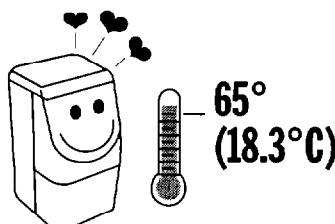
Instale el deshumidificador en un área donde la temperatura no descienda a menos de 65°F (18.3°C). Las temperaturas más bajas harán que se forme hielo en los serpentines.
