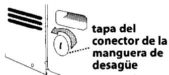
1. Use un destornillador de hoja plana para quitar la tapa del conector de desagüe. Gire la tapa en sentido contrario al de las manecillas del reloj. Tire la tapa. No puede usarse de nuevo.
