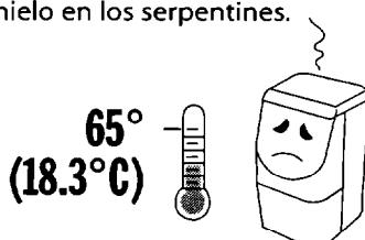
Si se forma hielo en los serpentines, algunos deshumidificadores continuarán el ciclo de encendido y apagado. Algunos deshumidificadores tienen una función de deshielo que automáticamente apaga el deshumidificador cuando se forma hielo. Desenchufe ambos tipos de deshumidificadores hasta que se derrita el hielo y suba la temperatura de la habitación.
