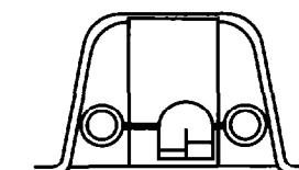
La posición "Low": deslice el Flotador de Nivel del Agua a la posición de "low", al lado derecho de la abertura, para que el balde esté más liviano. El deshumidificador se apagará automáticamente cuando el balde esté 1/2 lleno.
