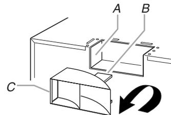
A. Lumbrera de escape del horno de microondas
