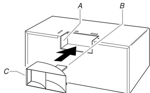
A. Lumbrera de escape del horno de microondas
