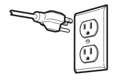
ENSURE PROPER GROUND EXISTS BEFORE USE. DO NOT REMOVE GROUND PRONG.
