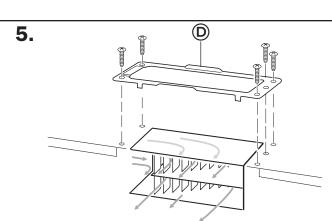
Réinstaller la plaque du volet de sortie
