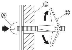
Visser manuellement les vis (a) et veiller à ce que les écrous articulés (c) soient bien ouverts derrière le panneau de gypse (c).
