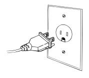
Brancher le cordon d'alimentation sur une prise de courant reliée à la terre. Rétablir l'alimentation électrique.
