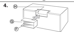
Réinsérer le déflecteur d'air dans sa cavité sur l'appareil, aussi loin qu'il peut aller. Veiller à ce que les pales de déflexion ⑤ soient orientées vers l'arrière de l'appareil et à ce que les petits orifices d'évacuation ⑥ et ⑪ soient placés face à face.
