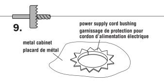
Avec une perceuse ou une scie à guichet, découper un trou de 5 cm (2 po) de diamètre à l'emplacement gris marqué M sur le gabarit.
