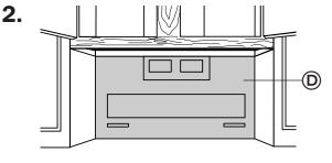
Positionner la plaque de montage © contre le mur. Enfoncer les vis A et écrous C à travers les trous du panneau de gypse E.
