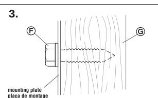
Étape critique Insérer 2, ou de préférence 4, vis d'ancrage 2 po x 1/4 po © dans les trous de 0,5 cm (3/16 po) percés dans les poteaux du colombage mural ©. Veiller à ce que le sommet de la plaque de montage soit aligné avec le bord avant du fond du placard ou du châssis du placard. Serrer fermement les vis d'ancrage et les boulons à écrou articulé.
