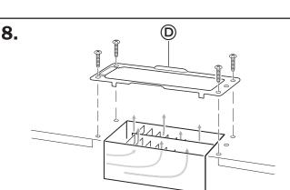
Réinstaller la plaque du volet de sortie
