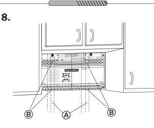
Déterminer si les points « D » et « E » ou « F » et « G » se trouvent au niveau d'un poteau du colombage (A). S'il y a un poteau, percer des trous de 0.5 cm (3/16 po). S'il n'y a pas de poteau, percer des trous de 1,9 cm (3/4 po) dans le panneau de plâtre.
