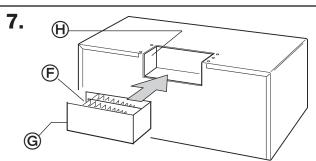
Réinsérer le déflecteur d'air dans sa cavité sur l'appareil, aussi loin qu'il peut aller. Veiller à ce que les pales de déflexion © soient orientées vers le sommet de l'appareil et à ce que les petits orifices d'évacuation © et ⊕ soient placés face à face.
