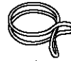
1 abrazadera plateada para manguera de alambre doble (parte inferior de la manguera de desagüe)
