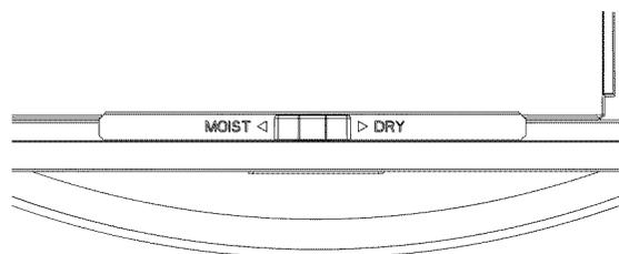
Le curseur de réglage Moist-Dry permet d'ouvrir ou de fermer les ouvertures d'aération dans la porte. Le réglage MOIST (humide) retient l'humidité tandis que le réglage DRY (sec) permet à la vapeur et à l'humidité de s'échapper du tiroir.
