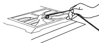
5. Pour le brûleur le plus proche de l'allumette, enfoncer et faire tourner le bouton du brûleur jusqu'à la position LITE/HI. Le brûleur s'allume immédiatement. Lorsque le brûleur est allumé, tourner le bouton jusqu'au réglage désiré.
