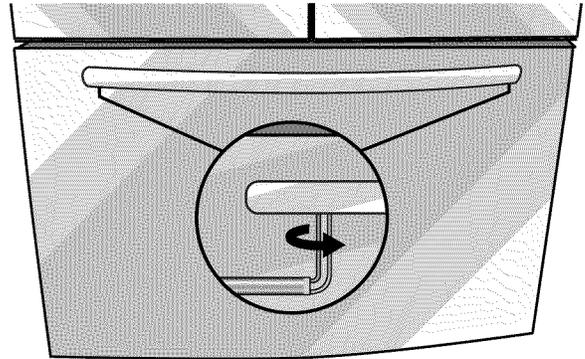
12. En tournant la clé de gauche à droite, serrer la vis de blocage d'un quart de tour à la fois, jusqu'à ce qu'elle commence à toucher la vis à épaulement. Ne pas serrer complètement.
