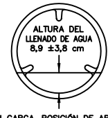
SIN CARGA, POSICIÓN DE ARRANQUE DEL CICLO PARA TALAS DE PLANCHADO PERMANENTE.
