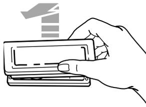
2. **Ôter** le couvercle en verre sur l'ampoule en saisissant le bord avant du couvercle et en le retirant hors de la paroi latérale du four.
