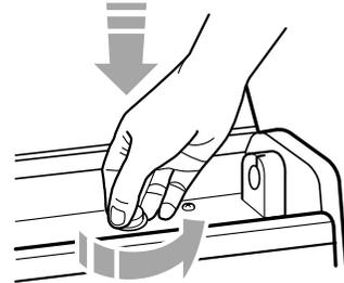
**Pour retirer et remplacer le démarreur, enlever d'abord le tube fluorescent.**
