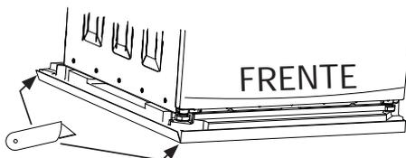
3. Con ayuda de otra persona, incline con cuidado el centro de lavado ligeramente hacia la izquierda como se muestra en la imagen siguiente. Primero retire el soporte de espuma para transporte del lado derecho solamente y después retire la base de espuma. Guarde estos artículos por si necesita usarlos en el futuro.
