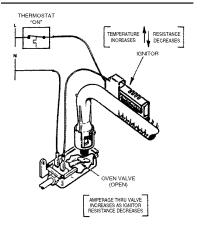
SERIES IGNITOR/VALVE CIRCUIT
