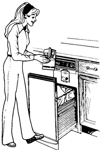
Lever et tirer la poignée ou appuyer sur la barre d'ouverture avec le pied.
