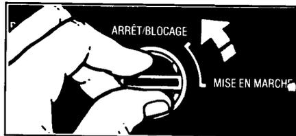
**Avant de procéder au nettoyage du presse-ordures**, mettre le bouton-clé en position ARRÊT/BLOCADE et l'enlever.
