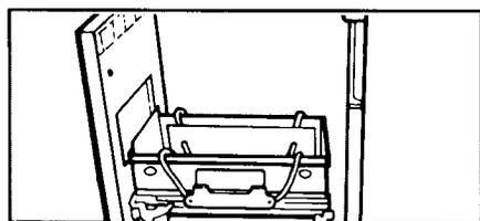
2. Mettre le compartiment à sac dans le tiroir. Glisser les courroies derrière les fixations, tel qu'il est illustré.
