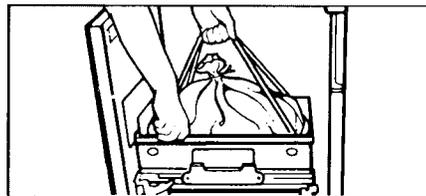
4. Retirer les courroies des fixations latérales et les tenir. **Pour faciliter l'enlèvement du sac**, ouvrir le côté du tiroir en déclenchant le loquet situé à l'avant. Soulever le sac et le compartiment du tiroir.
