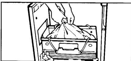
3. Fermer le sac avec les attaches à torsion fournies.
