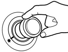
3. Si su secadora tiene un selector de temperatura, fíjelo en el ajuste recomendado para el tipo de tela que esté secando. Vea “Ciclos” para las sugerencias de temperatura.
