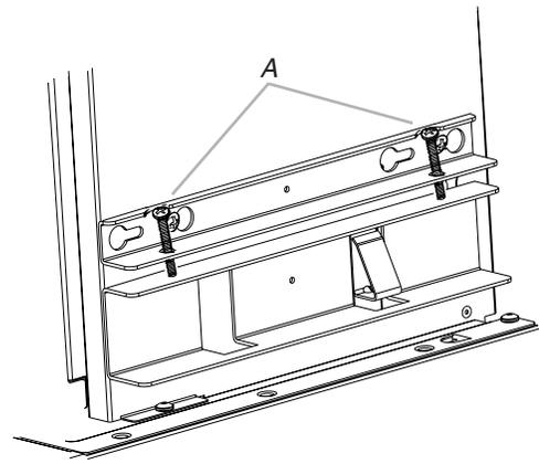
A. Vis de nivellement de 5 x 18 mm
