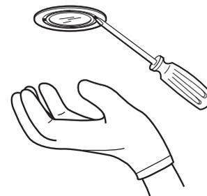
3. Installer une ampoule à halogène de 12 V (maximum 20 watts) avec culot GU-4.
