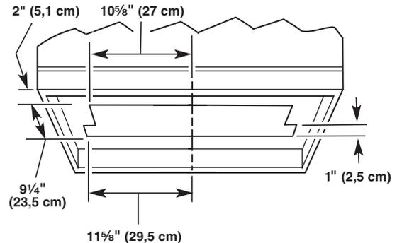
4. Si le fond du placard forme une cavité au-dessus d'un cadre de support, on devra installer des tringles d'appui en bois à droite et à gauche de l'ouverture découpée afin de laisser suffisamment d'espace pour pouvoir manoeuvrer l'élément coulissant. Les cales en bois doivent être en affleurement ou en retrait de  $\frac{1}{16}$ " (1,6 mm) à  $\frac{1}{8}$ " (3,2 mm) par rapport au fond du cadre de support.
