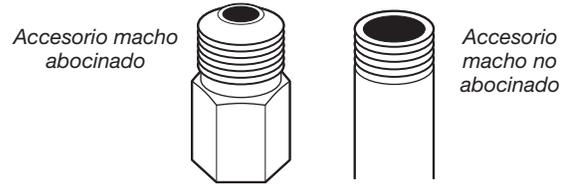
Quite la tapa roja del tubo de gas. Utilizando una llave de tuercas para ajustar, conecte el suministro de gas a la secadora. Use compuesto para unión de tubos en las roscas de todos los accesorios macho no abocinados. Si se usa tubería flexible de metal, asegúrese de que no hayan partes retorcidas.
