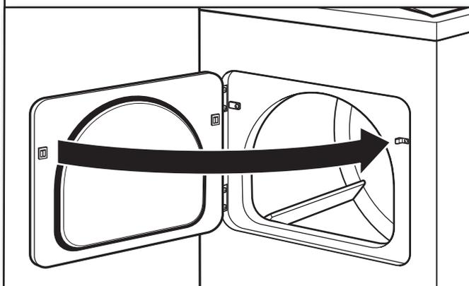
Cierre la puerta y asegúrese de que el tope de la misma esté alineado con el seguro de la puerta. Si es necesario, deslice el seguro de la puerta hacia la izquierda o derecha dentro de la ranura a fin de ajustar la alineación.
