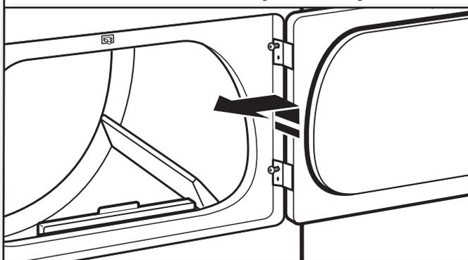
Levante la puerta hasta que los tornillos superiores de la carcasa estén en la parte grande de la ranura de la bisagra. Jale la puerta hacia adelante para separarla de los tornillos. Coloque la puerta (con el lado de la manija hacia arriba) encima de la secadora. Extraiga los tornillos superiores de la carcasa de la secadora.
