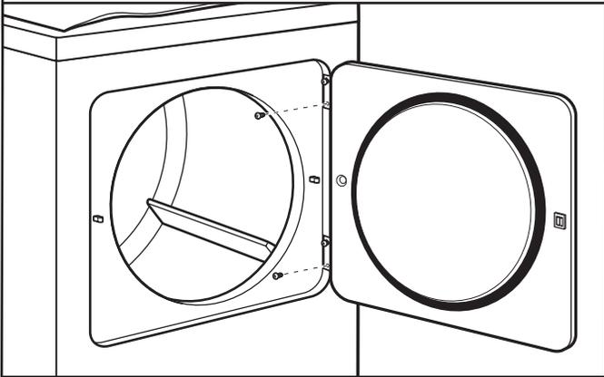
Abra la puerta de la secadora. Extraiga los tornillos inferiores de las bisagras del lado de la carcasa. Afloje (no extraiga) los tornillos superiores de las bisagras del lado de la carcasa.
