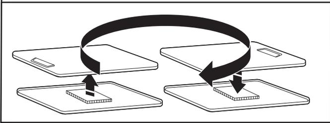
Tome la puerta exterior, gírela 180° y colóquela de nuevo sobre la puerta interior. Asegúrese de mantener el espaciador de cartón centrado entre las puertas. Vuelva a sujetar el panel exterior al panel interior de la puerta, de modo que la manija quede en el lado en donde recién se han quitado las bisagras. Inserte los 4 tornillos de la puerta.
