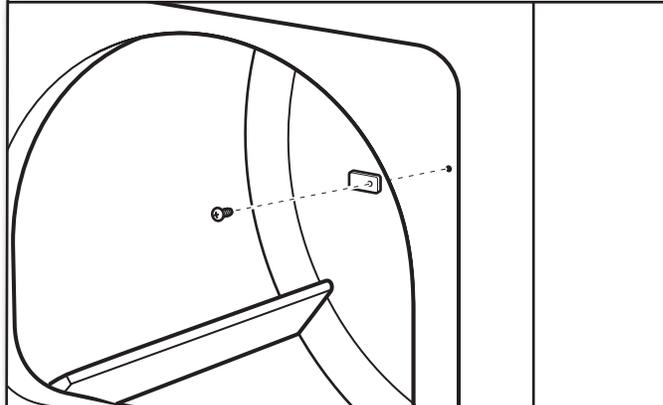
Extraiga el tapón del tope de la puerta. Introduzca el tope de la puerta que usted quitó en el paso 9 en el orificio, y asegúrelo con un tornillo. Introduzca el tapón del tope de la puerta en el orificio original del tope de la puerta y asegúrelo con un tornillo.
