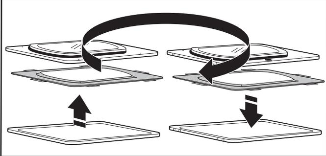
Tome la puerta exterior, gírela 180° y colóquela de nuevo sobre la puerta interior. Asegúrese de mantener el espaciador de cartón centrado entre las puertas. Vuelva a sujetar el panel exterior al panel interior de la puerta, de modo que la manija quede en el lado en donde recién se han quitado las bisagras. Inserte los 4 tornillos de la puerta.
