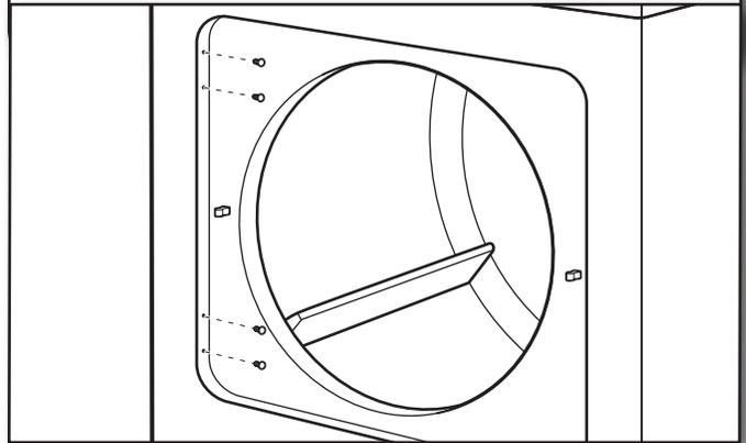
Use un destornillador pequeño de hoja plana para quitar con cuidado los cuatro tapones de los orificios de la bisagra que están en el lado izquierdo de la carcasa. Introduzca los tapones en los orificios de la bisagra en el lado opuesto de la carcasa de la secadora.
