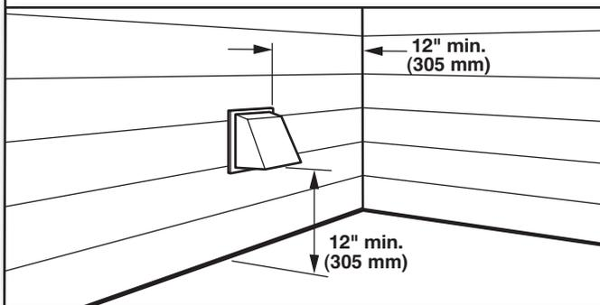
Instale la capota de ventilación y use compuesto para calafateo para sellar la abertura exterior de la pared alrededor de la capota de ventilación.
