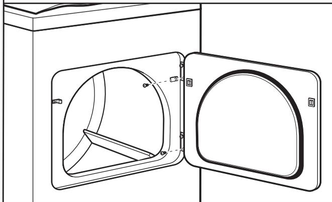
Abra la puerta de la secadora. Extraiga los tornillos inferiores de las bisagras del lado de la carcasa. Afloje (no extraiga) los tornillos superiores de las bisagras del lado de la carcasa de la secadora.
