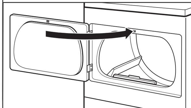
Cierre la puerta y asegúrese de que el tope de la misma esté alineado con el seguro de la puerta. Si es necesario, deslice el seguro de la puerta hacia la izquierda o derecha dentro de la ranura a fin de ajustar la alineación.
