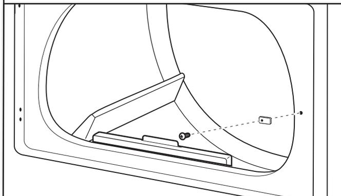
Saque el tapón del tope de la puerta. Inserte el tope de la puerta que se quitó en el Paso 10 dentro del orificio y asegúrelo con el tornillo. Inserte el tapón del tope de la puerta en el orificio del tope original de la misma y asegúrelo con un tornillo.
