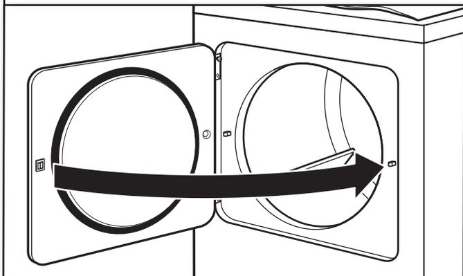
Cierre la puerta y asegúrese de que el tope de la puerta está alineado con el seguro de la puerta. Si es necesario, deslice el seguro de la puerta hacia la izquierda o derecha dentro de la ranura para ajustar la alineación.
