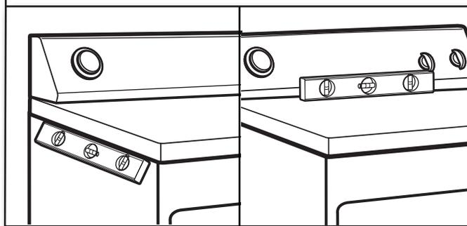
Revise la nivelación de la secadora de lado a lado. Repita el procedimiento de adelante hacia atrás.
