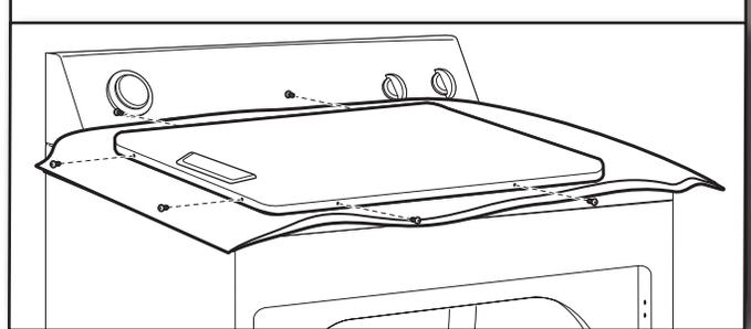
Quite los tornillos de la parte superior, inferior y lateral de la puerta (6 tornillos). Mantenga los tornillos de la puerta separados de los tornillos de la bisagra, ya que son de distintos tamaños. Sosteniendo la puerta sobre la toalla encima de la secadora, sujete los lados de la puerta exterior y levántela para separarla de la puerta interior.
