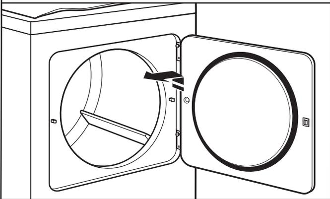
Levante la puerta hasta que los tornillos superiores de la carcasa estén en la parte grande de la ranura de la bisagra. Jale la puerta hacia adelante para separarla de los tornillos. Coloque la puerta encima de la secadora. Extraiga los tornillos superiores de la carcasa de la secadora.
