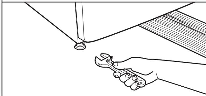
Si la secadora no está nivelada, levántela colocando un bloque de madera debajo de la misma, use una llave de tuercas para regular las patas hacia arriba o hacia abajo y revise nuevamente si está nivelada. Una vez que las patas estén niveladas, cerciérese de que las cuatro patas estén ajustadas contra el suelo antes de apretarlas.
