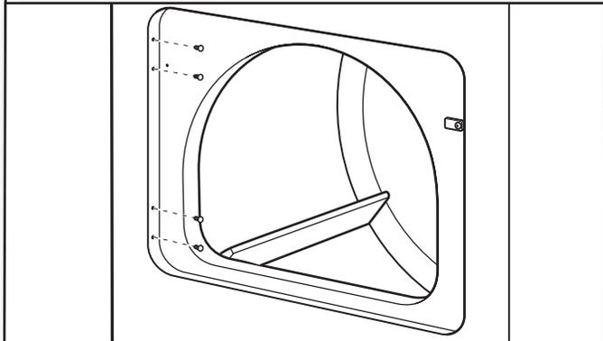
Use un destornillador pequeño de hoja plana para quitar cuidadosamente 4 tapones de los orificios de las bisagras en el lado izquierdo de la carcasa de la secadora. Mueva los tapones de los orificios de la bisagra al lado opuesto de la carcasa de la secadora.
