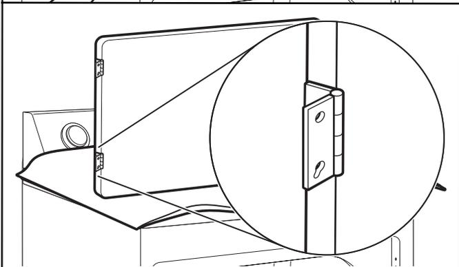
Fije las bisagras de la puerta a la puerta de la secadora, de manera que el orificio más grande quede en la parte inferior de la bisagra.
