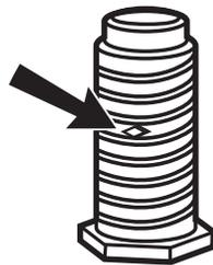
Examine las patas niveladoras; localice la marca en forma de diamante. Atornille con la mano las patas en los orificios de las mismas y use una llave de tuercas para terminar de atornillar las patas hasta que la marca en forma de diamante no quede visible.
