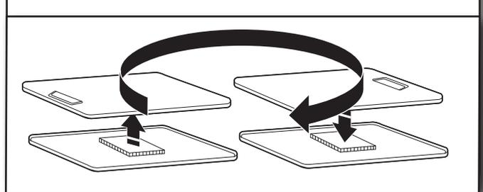
Tome la puerta exterior, gírela 180° y colóquela de nuevo sobre la puerta interior. Asegúrese de mantener el espaciador de cartón centrado entre las puertas. Vuelva a sujetar el panel exterior al panel interior de la puerta, de modo que la manija quede en el lado en donde recién se han quitado las bisagras. Inserte los 6 tornillos de la puerta.
