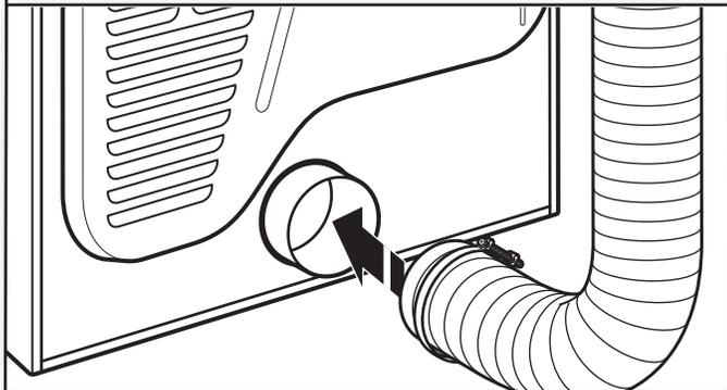
Usando una abrazadera de 4" (102 mm), conecte el ducto de escape a la salida de aire de la secadora. Si se conecta a un ducto de escape existente, asegúrese de que el mismo esté limpio. El ducto de escape de la secadora debe encajar sobre la salida de aire de la secadora y dentro de la capota de ventilación. Cerciérese de que el ducto de escape esté asegurado a la capota de ventilación con una abrazadera de 4" (102 mm).
