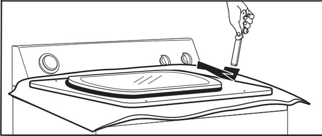
Sosteniendo la puerta sobre la toalla encima de la secadora, palanca la puerta interior y levántela para separarla de la puerta exterior.
