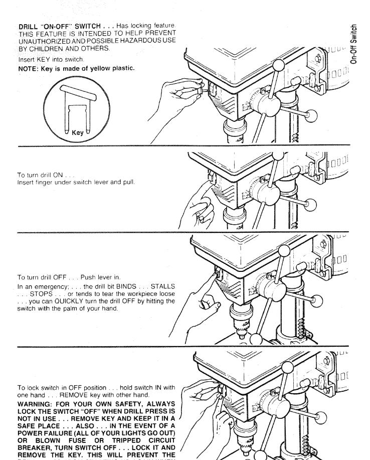
DRILL PRESS FROM STARTING UP AGAIN WHEN THE POWER COMES BACK ON.
