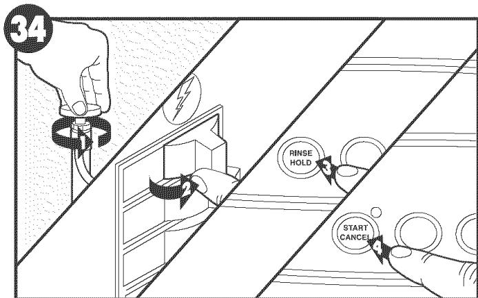
Turn on water, power and machine / Abra la llave de agua, conecte la corriente y encienda el aparato / Ouvrir le robinet d'eau, l'alimentation et mettre en marche
