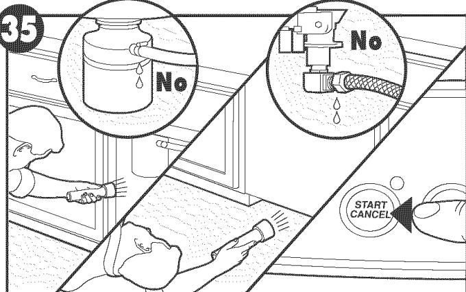
Check for leaks, turn off machine / Verifique si hay fugas, apague el aparato / Vérifier l'absence de fuites, mettre à l'arrêt
