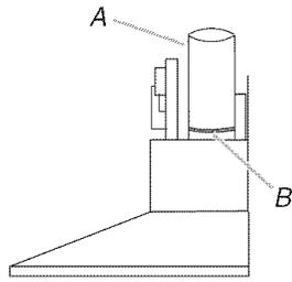
A. Conduit métallique rond de diamètre 6" (15,2 cm)
