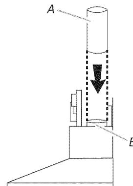
A. Conduit métallique rond de diamètre 6" (15,2 cm)
