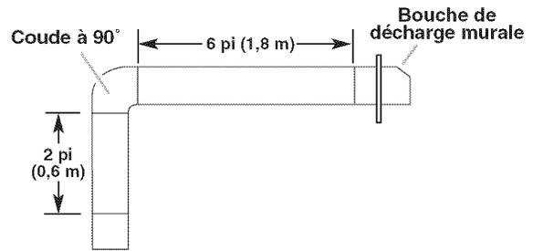
Dans l'exemple suivant, la longueur théorique du circuit est inférieure au maximum de 35 pi (10,7 m).
