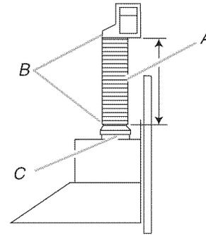
A. Conduit métallique flexible, diamètre 5" (12,7 cm)
