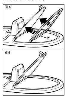
为更换整个锅盖边缘四周的密封件, 把密封件的边缘从一端到另一端缓慢装 回锅盖上。密封件将牢牢卡在锅盖底 部周围唇缘的两边,并拉伸以实现 完全匹配。
