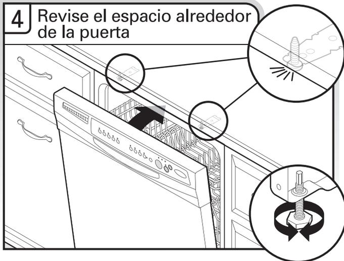
Revise que la parte superior de la puerta no haga contacto con los tornillos, los soportes o el mostrador. Si esto sucede, regule las patas niveladoras.
