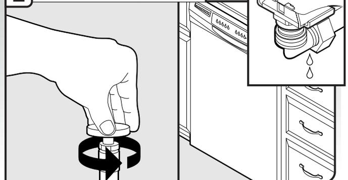
Coloque una toalla de papel debajo del codo de 90°. Abra la llave de suministro de agua y revise si hay fugas. Si hay fugas, repita el paso anterior.
