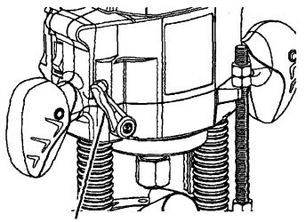
PLUNGE LOCK LEVER SHOWN IN ORIGINAL LOCKED POSITION
